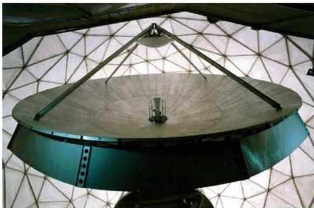
Figura 3: Radiotelescopio de 14 metros de Yebes con el receptor de bandas S/X utilizado en observaciones de VLBI astronómico y geodésico.
