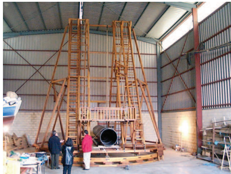
Figura 11: Montaje inicial en Bermeo de las partes mecánicas del Telescopio de Herschel durante una visita técnica del autor.
