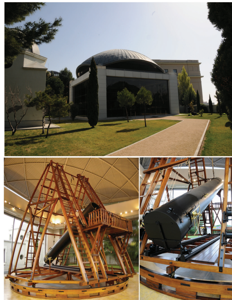
Figura 12: Telescopio de Herschel reconstruido: a) Vista exterior del Pabellón; b) vista general del telescopio; c) detalles del tubo con clinómetro y anteojo buscador.
