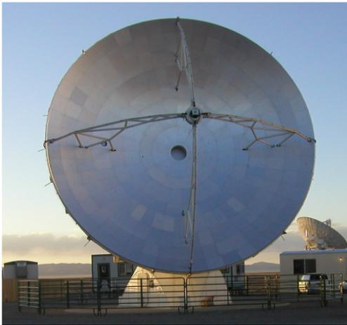
Figura 5: Uno de los prototipos de antenas de ALMA en que el OAN ha participado en la realización de medidas holográficas de su superficie.
