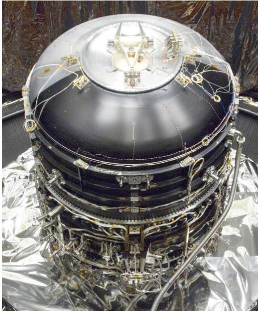
Figura 4: Criostato instalado en un banco de pruebas.
