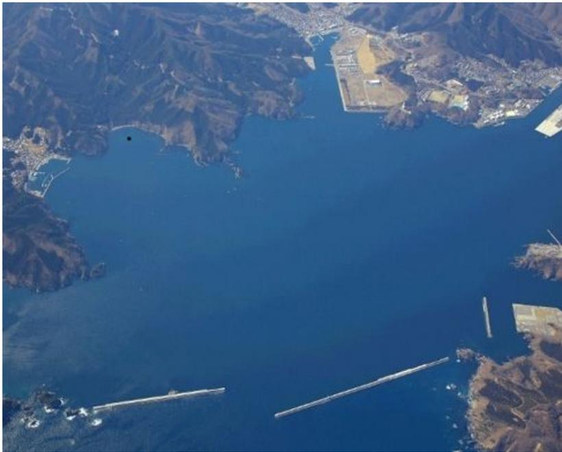
Figura 7: Rompeolas de protección contra los tsunamis de 63 metros de profundidad (obtuvo el récord de rompeolas más profundo del mundo). Fuente: (Japan Probe, <http://www.japanprobe.com>)
